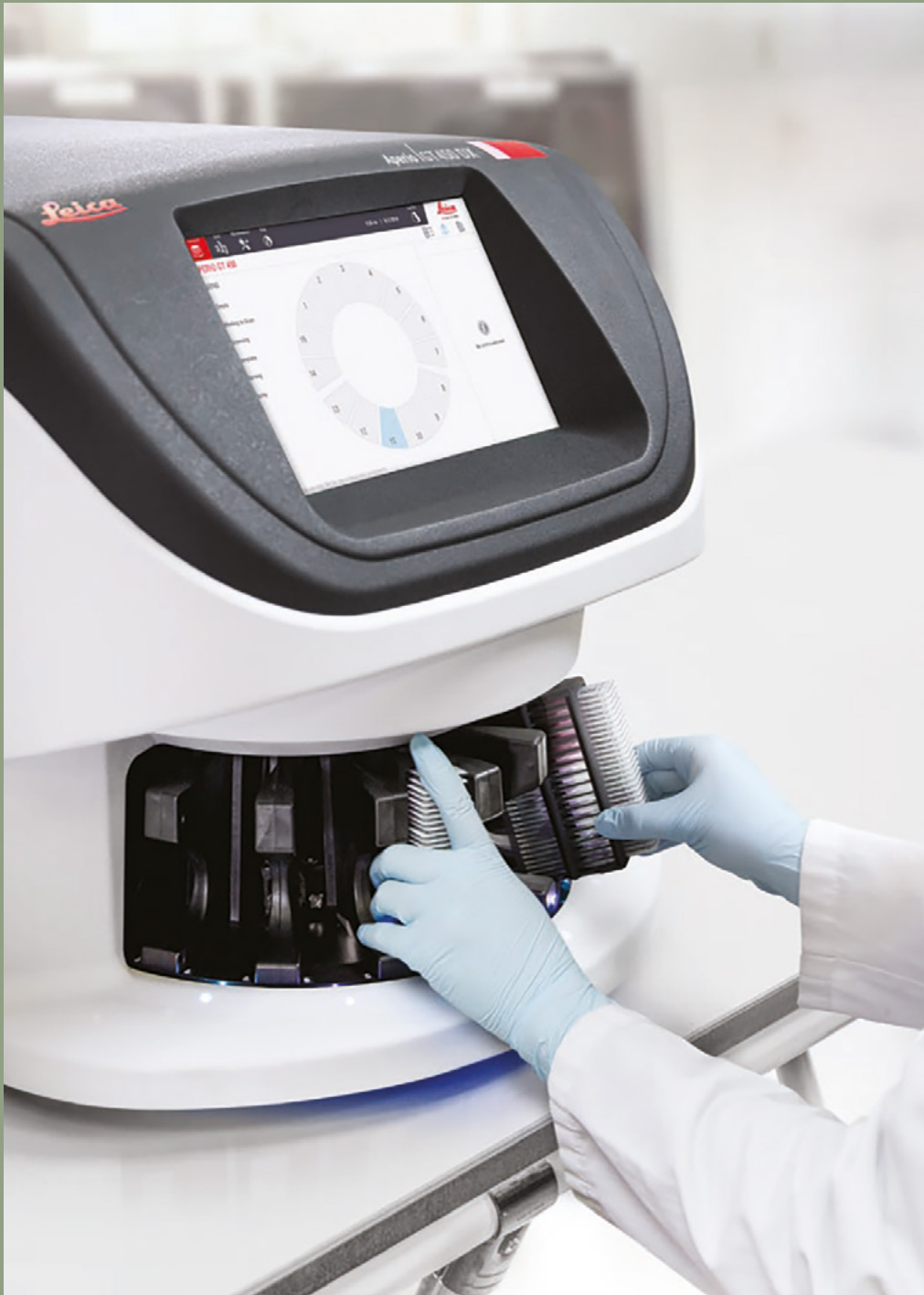
En stor og brukervennlig trykkskjerm viser status på skanner kurver ved hjelp av fargekoder. Grønn for ferdigskannet og blå for kurver som skal skannes.
