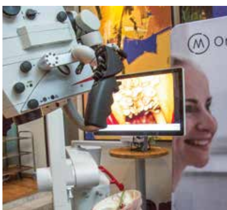
Leica GLOW800 augmented reality (AR), fluorescens og ICG
